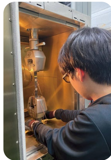
構造物の試験片の引張試験を行っている須永さん。実際の構造物を宇宙で見込まれる高温・低温環境で動作させる前に、材料特性を取得して数値シミュレーションに活用する。
